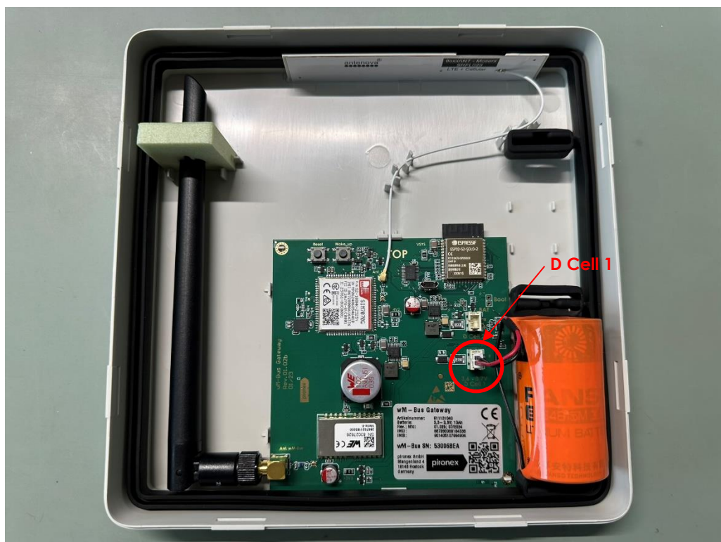
Abbildung 3: Batteriemontage (eine Batterie)
