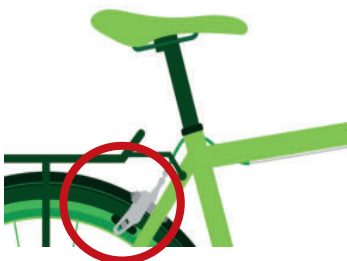
Das Rahmenschloss wird an der gelochten Hinterbaustrebe montiert
